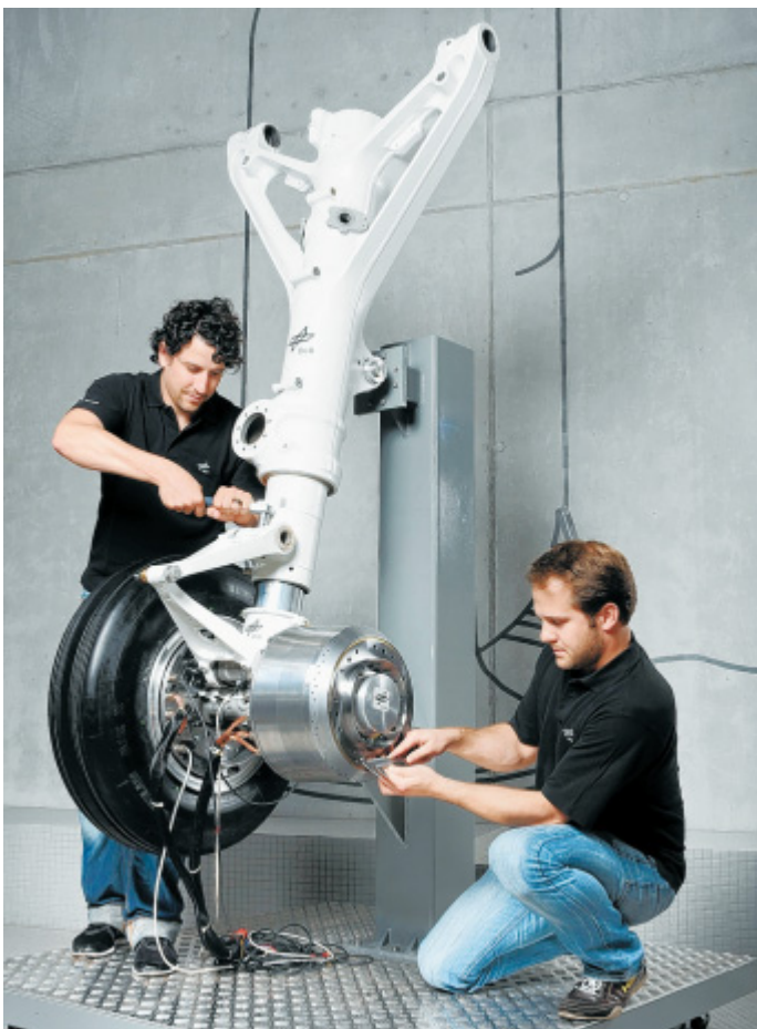
Im Labor erfolgreich getestet: Der Bugradantrieb besteht aus zwei elektrischen Motorantrieben, die in den zwei Felgen des Flugzeugbugrades eingebaut sind. FOTO: DLR
